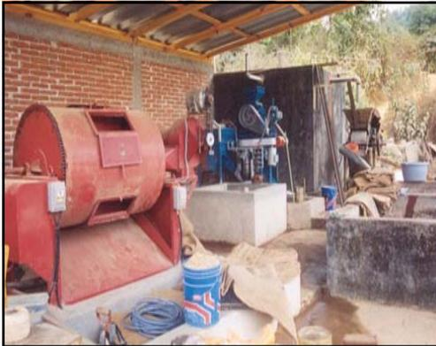
Módulo de Beneficiado Húmedo adaptado con despulpadora ecológica
