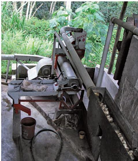
mientras el café despulpado se clasifica en la zaranda y luego pasa al cuello de ganso mediante un sistema por gravedad (primera, segunda, etc.) continuando hacia el proceso de fermentación.
