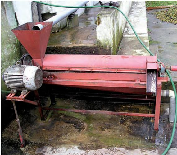
En este proceso el café es seleccionado por su peso, separándose aquellos granos que flotan (vanos, brocados, entre otros) en la corriente de agua, los cuales por su defecto, producen disminución de la calidad en taza.
