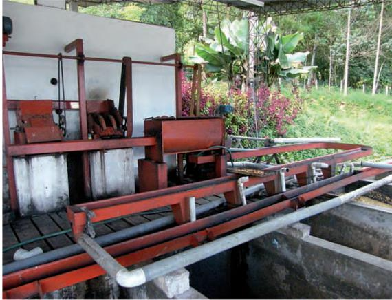
Se realiza con despulpadoras de cilindro o disco. Consiste en desprender la pulpa y parte del mucílago adherido a ella, enviándola a la compostera,
