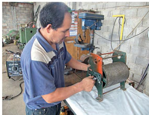
Encamisado y calibrado de la despulpadora
