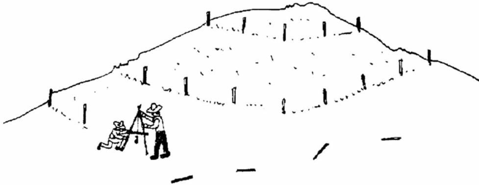
Para este trazo se sigue la pendiente del terreno, iniciando por la parte más quebrada. Con las curvas a nivel sucede muy comúnmente que los surcos se abran o se cierren demasiado. Cuando se abren el doble de la distancia de siembra se marca un nuevo surco, si por el contrario se cierran se elimina un surco o los que sean necesarios.
