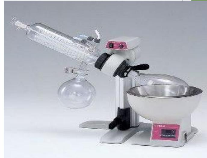
Este método emplea cloruro de metileno como disolvente químico. Los granos verdes se humedecen en agua para que la superficie del grano se vuelva porosa, y se dejan en remojo en cloruro de metileno hasta que la cafeína se haya disuelto. El disolvente se elimina mediante un evaporador y después se lavan los granos. Después de ello se secan con aire caliente. El cloruro de metileno se reutiliza para posteriores procesos de descafeinado.
