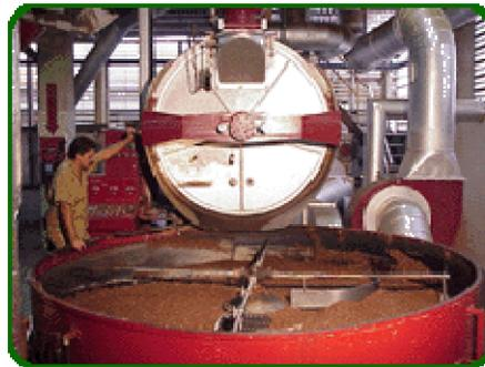
Una vez logrado el punto de tostado deseado el café pasa de la tostadora a un plato de enfriamiento que mediante un muy eficiente aspirador de aire logra bajarle al grano la temperatura niveles muy cercanos a la temperatura ambiente para que luego se almacene en silos con el fin de que termine de refrescar.
